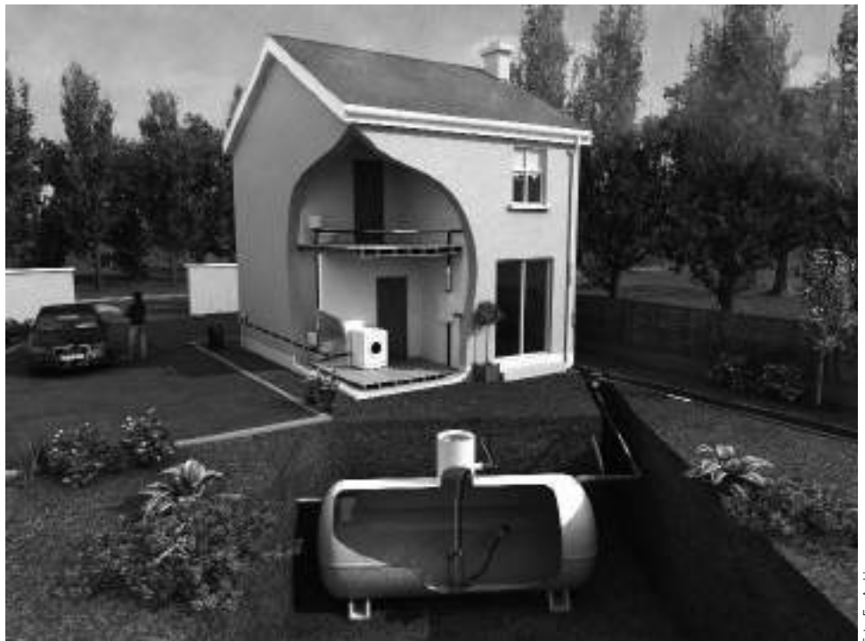
Depósito enterrado de aguas fluviales
